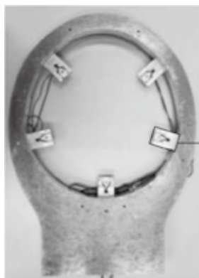
(a) 便座に設置した UVC-LED 装置(5-LED)
